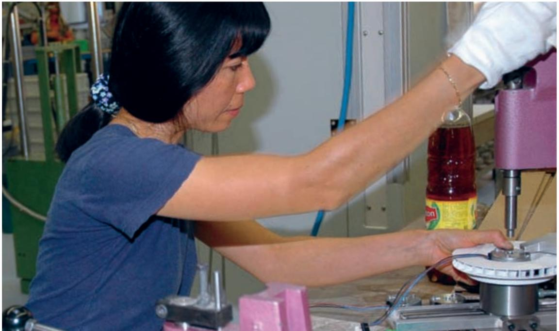
Areevon Rutz fügt den Elektromotor, der nur gerade sechs Watt verbraucht, mit dem Lüftungsrad zusammen. In der Firma Trivent, wo sie seit 2006 arbeitet, schätzt sie die hohe Präzisionsarbeit
