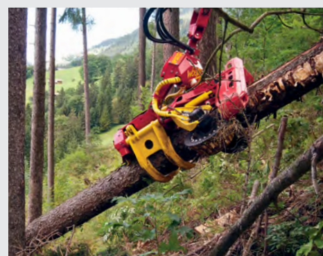
In Sekundenschnelle werden die Bäume vom Baggerprozessor entastet und zugeschnitten.
