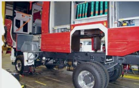
Nachdem der Aufbau auf das Chassis des Volvo montiert wurde, erfolgt nun der Einbau der Gerätschaften.
