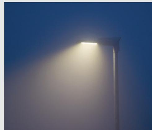
Die neuen LED-Lampen verbrauchen im Vergleich zu den Natriumgasdampflampen weniger Energie. Zudem ist in der Dämmerung bei leichtem Nebel gut zu erkennen, dass ihr Lichtkegel viel stärker gebündelt ist. Die Lichtverschmutzung wird so auf ein Minimum reduziert.
